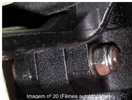
A abraçadeira que aperta o suporte do carreto ao tubo vem de origem com um parafuso de 2,5 mm e uma fêmea normal. Substituí o parafuso por um de 3 mm com uma fêmea autoblocante (optei por um parafuso de 3mm porque não encontrava fêmea autoblocante para 2,5mm). Outra alternativa é utilizar o parafuso/fêmea de origem e colocar loctite na rosca para a fêmea não desapertar.
