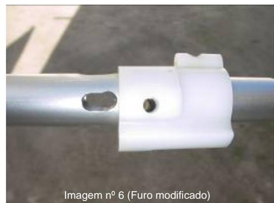
Todos os furos foram alargados com uma broca de 5mm. Depois de furar é aconselhável eliminar as rebarbas para não riscar o tubo e não danificar o oring do pistón.
